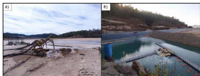
Figura 7. Descarga: (a) jales ciclados en TSF-2 y (b) agua recuperada en TSF-1 .
