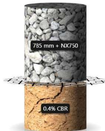
Figura 5. Sección mecánicamente estabilizada con geomalla multiaxial.
