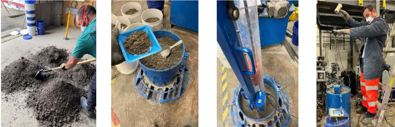
Figura 6. Calibración en laboratorio para obtención de las curvas de referencia (a) muestreo, (b y c) confección y compactación de las muestras en el molde de calibración y (d) realización de los ensayos P.A.N.D.A® para cada muestra confeccionada (gentileza de Newmont, Canada).
