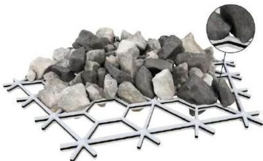
Figura 1. Geomalla Multiaxial y trabazón mecánica.
