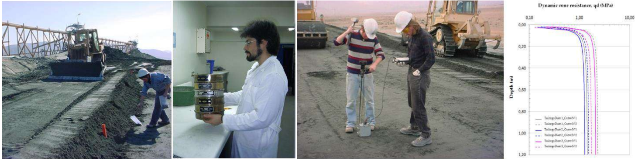
Figura 3. Control de compactación de jales mineros con P.A.N.D.A®. calibración in-situ mediante cancha de prueba y determinación de las curvas de referencia.
