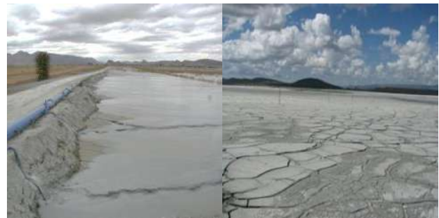
Figura 4. Izq.: jales siendo depositados en una playa; der.: jales disecados y con fisuras superficiales.
