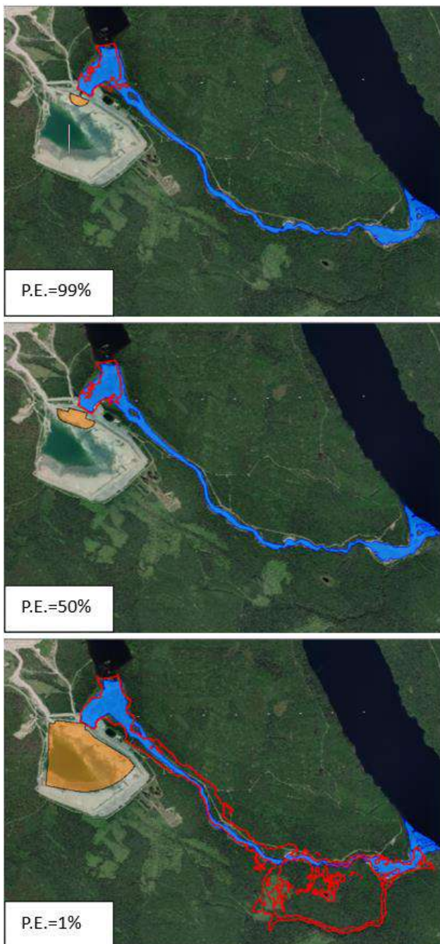
Figura 6. Contornos de manchas de inundación para los tres escenarios considerados (en rojo), superpuestos a la mancha de inundación real (en azul). En naranja, vista en planta de la superficie de falla cónica. Nótese la diferencia entre la inundación modelada vs la observada en el caso de P.E.=1% en el encuentro del lago de la derecha, causada por la utilización de topografía obtenida de la base de datos pública SRTM.
