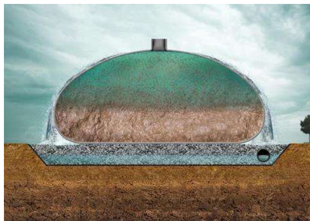
Figura 2. Sección transversal tubo geosintéticos SoilTain – Huesker
