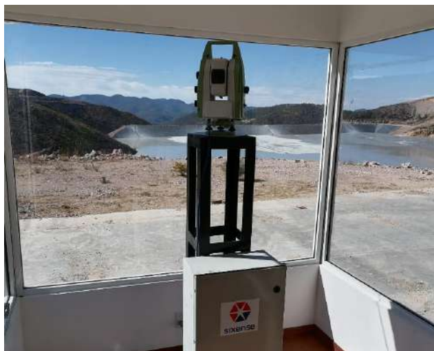
Figura 9. Ejemplo de implementación de estación total robotizada en presa de jales.
